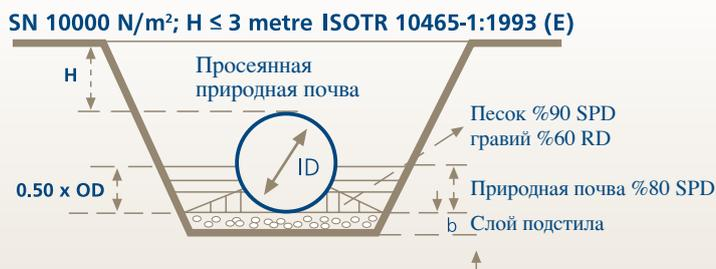
До 25% от внешнего диаметра трубы, производится гранулярное заполнение.
