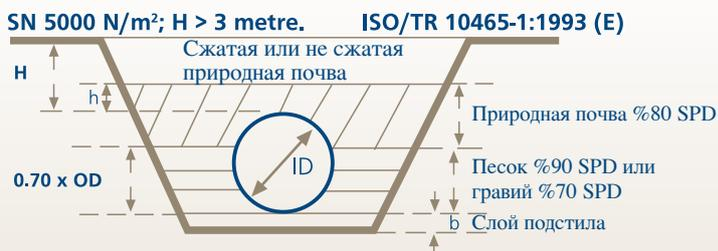
До 70% от диаметра трубы, производится гранулярное заполнение, после чего на расстояние (h) наполняется просеянный сжатый природный наполнитель. Это высота (h) мин. 100 макс. 300 мм.
