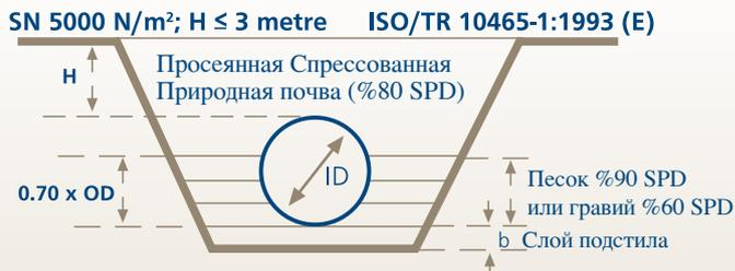
До 70% от внешнего диаметра трубы, производится гранулярное заполнение.
